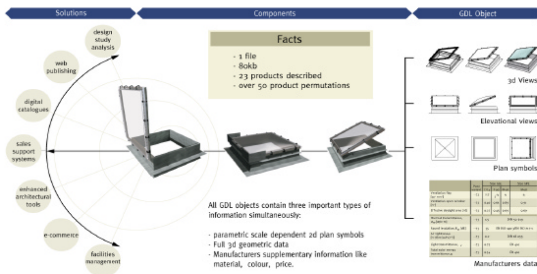
Figur 1 Velux fönster beskrivet med hjälp av GDL
